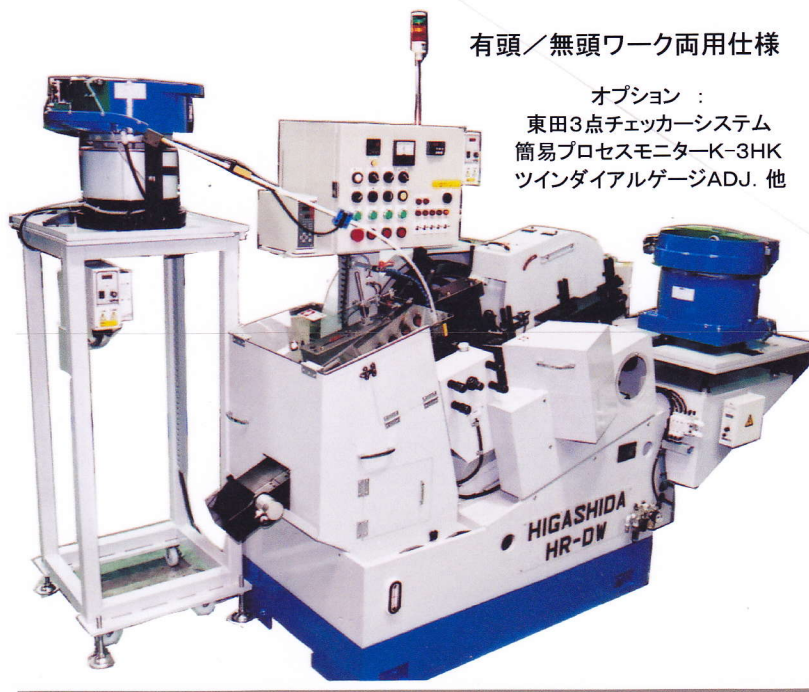
オプション プロセスモニター K-3HK (転造圧デジタル監視装置)
